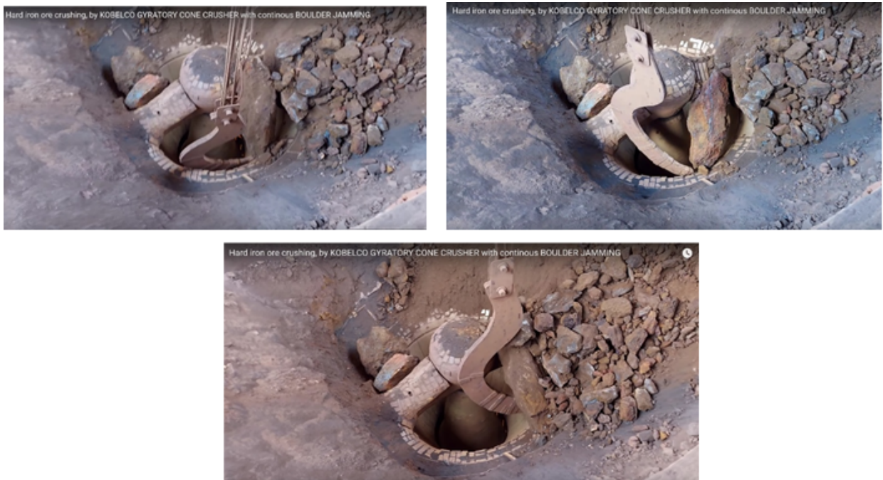
Рисунок 1. Зліва направо, зверху вниз – процес послідовної ліквідації зависання в живильному тракті дробарки
