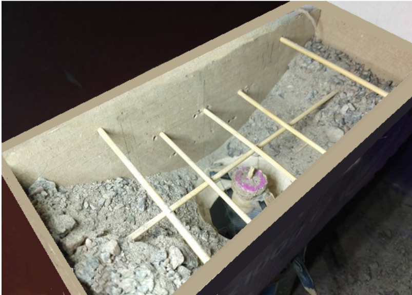
Рисунок 4. Лабораторна модель для шостої серії експериментів, яка дала найменшу ймовірність виникнення зависань матеріалу
