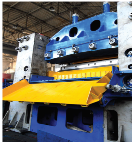
Рисунок 5. Конструкція ножиць для поперечного розрізання плоского металопрокату з шевронним ножем («НКМЗ», м. Краматорськ, Україна)
